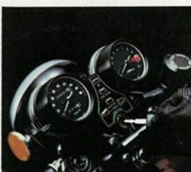
● Dobbelt-sidet tændingsnøgle i instrumentpanelet aflæser styret, når det tages ud.
