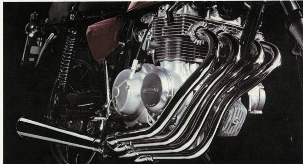
● Spændende 4-i-1 udstedningssystem supplerer caféracerens udseende, reducerer vægten og forstærker drejningsmomentet i den tæt-ribbet 4-cylinder 4-takt overliggende knastaksel motor med 6-trins gearbox og elektrisk starter.
