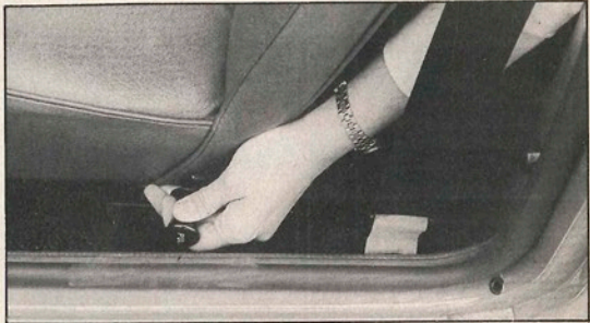
▲ Der er solide låse på forsæderne, men monteringen er sjuksket udført, og de er tre-kantede at betjene, hvad enten man skal gøre det udefra eller fra bagsædet.
