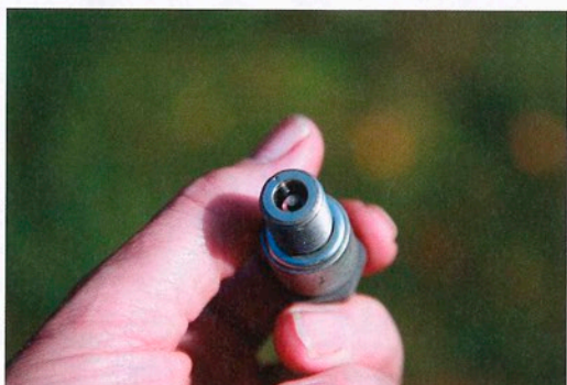
Tændrøret er specielt ved, at det har en indvendig sideelektrode.
