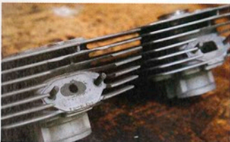
Til venstre ses den droslede og til højre den udroslede, som de første var forsynede med.
